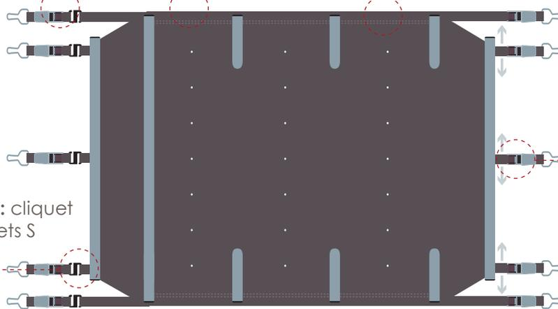
Les couvertures à barres Securit Pool **Hors sol Woody** sont conçues à partir de tissu enduit PVC 650 g/m<sup>2</sup> et composées d'un système de maintien au moyen de barres en aluminium anodisé.
