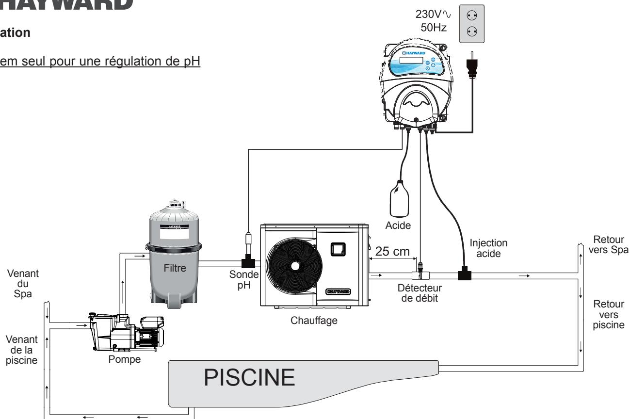
EZ-Chem avec kit ORP pour une régulation de pH et injection de chlore liquide.
