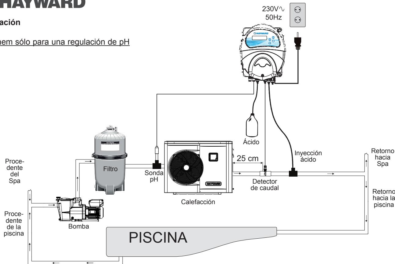
EZ-Chem con kit ORP para una regulación de pH e inyección de cloro líquido.
