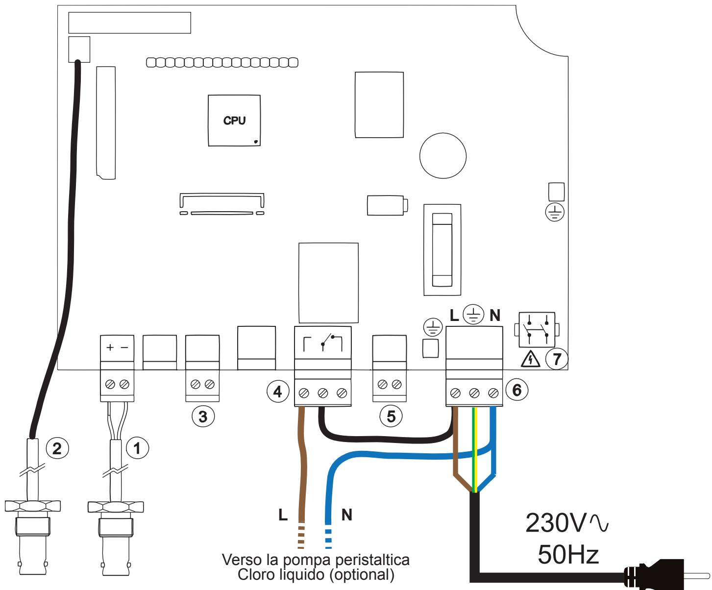
1 Presa BNC per la sonda pH
