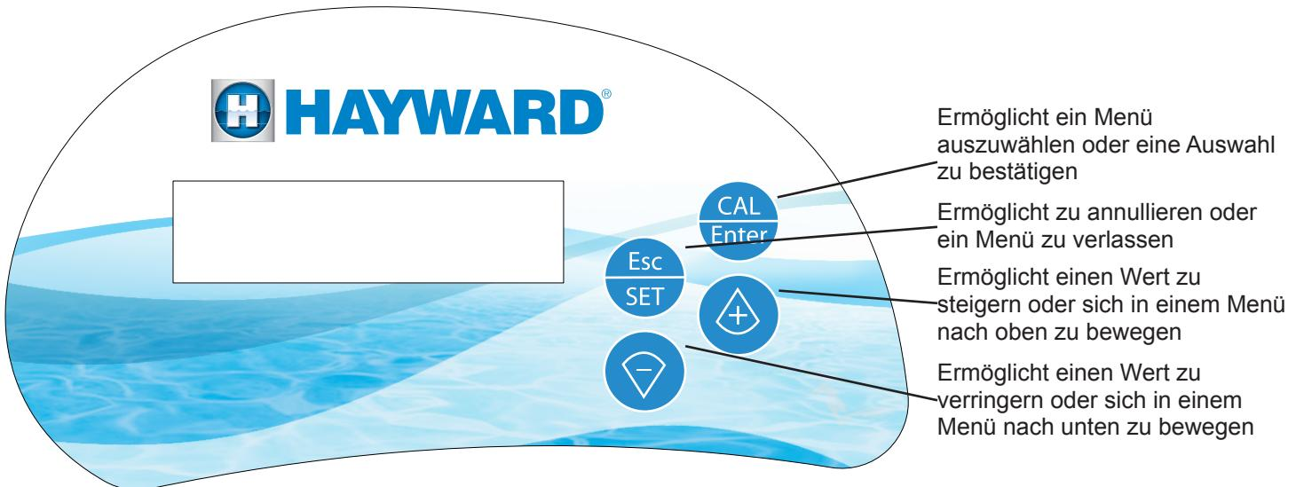
Um das Gerät zu konfigurieren drücken Sie gleichzeitig 5 Sekunden lang auf **CAL Enter** und **Esc SET**, damit auf dem Bildschirm Folgendes angezeigt wird.
