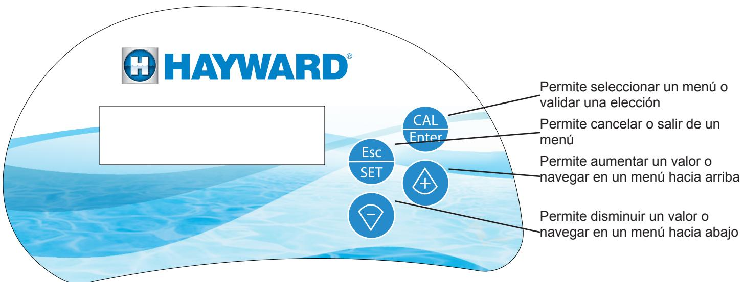
Para configurar el aparato, pulse simultáneamente
