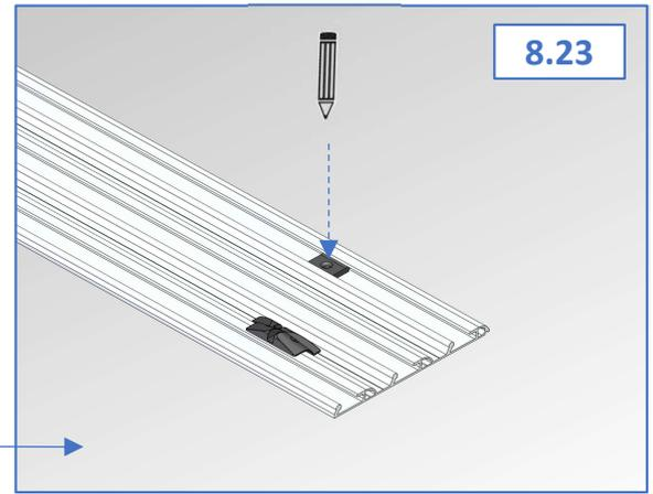
En cas du sol bétonné percer les trous avec une meche de diam. 6mm puis répéter-le avec une meche de diam. 10mm. La profondeur des trous doivent être 60mm.
