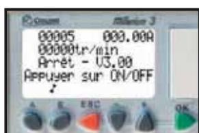
Sur le même cycle d'ouverture ou de fermeture, si cette erreur se produit 3 fois, cet affichage clignotera avec l'écran ci-contre. Pour réinitialiser le système, il faut appuyer sur l'interrupteur Marche - Arrêt du coffret.
