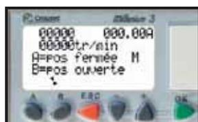
1. Amener la couverture en position fermée en actionnant la clé sur « fermeture ».
